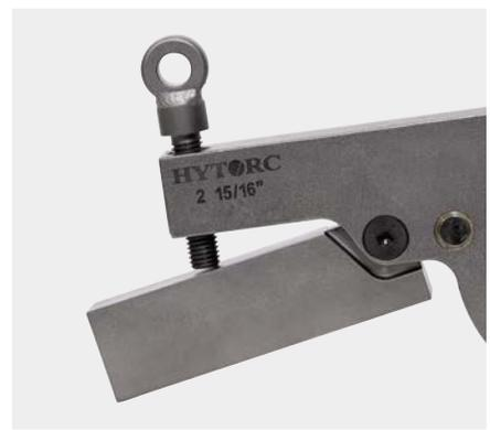
バックアップレンチには、さまざまな構成での設置を簡素化する調整可能なアームが付属しています。アームのアイボルトを調整して、レンチを所定の位置にすばやくロックしたり、ボルト締め操作後にロックを解除したりできます。落下の危険を防ぐために、アイボルトにストラップを追加します。
