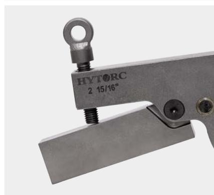
A chave de apoio conta com um braço ajustável que facilita sua instalação nas mais diversas configurações. O parafuso olhal do braço pode ser ajustado para travar a chave rapidamente no ponto desejado e destravá-la após a operação. Insira um talabarte no olhal para minimizar riscos de queda.
