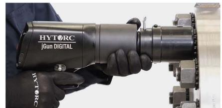
Alle HYTORC Pneumatischen Drehmomentwerkzeuge sind mit hocheffizienten und ruhigen Drehmomentverstärkern ausgestattet, die weniger Vibrationen übertragen als andere Werkzeuge. Alle diese Werkzeuge bieten eine höhere Leistung, ohne die Sicherheit des Personals zu kompromittieren, da sie den Nutzer niedrigeren Vibrationen aussetzen.
