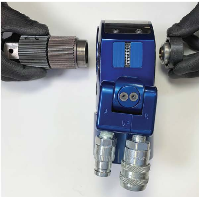
Einrichtung des Werkzeugs für Festziehen
