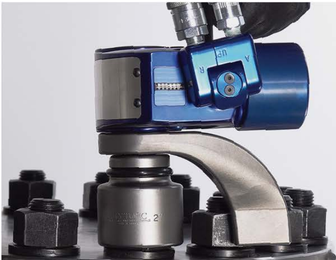
Verschrauben mit Drehmomentstütze auf Antriebsverzahnung
