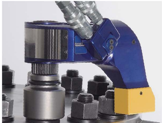
Verschrauben mit Drehmomentstütze auf rückseitiger Verzahnung
