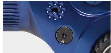
La llave **MXT+** tiene una función de liberación automática integrada para que el operador no tenga que mover una palanca para liberar la herramienta de la aplicación. Simplemente haga avanzar la bomba y la herramienta se liberará, haciendo que las operaciones de empernado sean más rápidas, seguras y sencillas.
