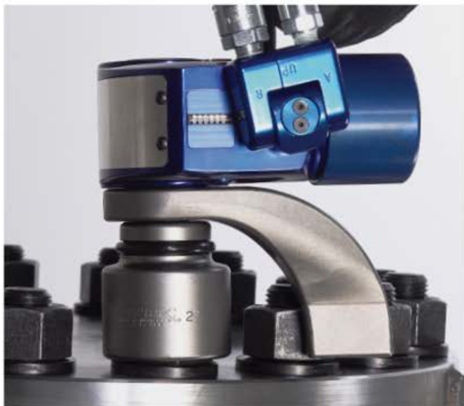
Bullonatura con braccio di reazione a scanalatura dell'attacco
