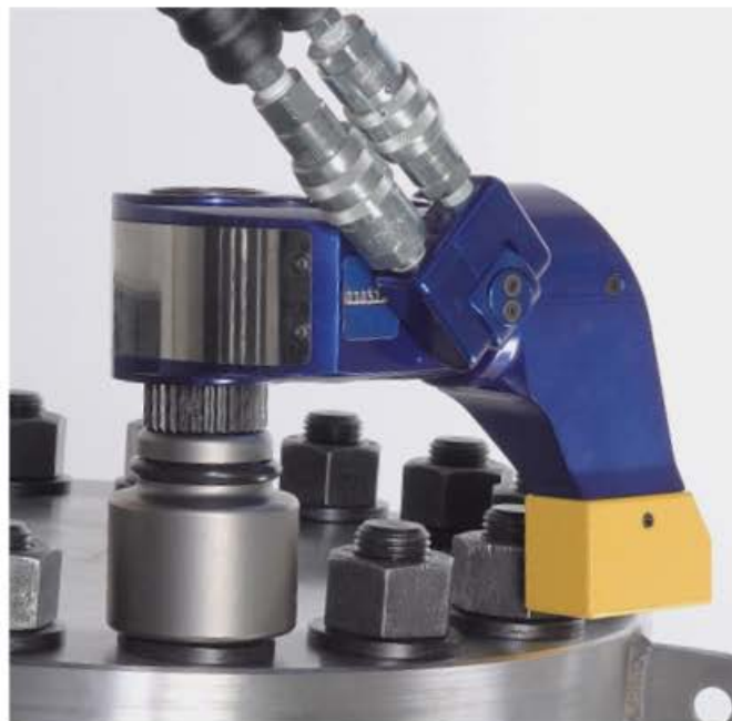
リアスプラインリアクションアームによるボルト締め
