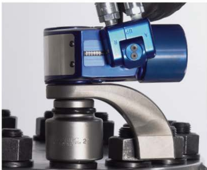
Aparafusando com o braço de reação na ranhura do acionador da ponta quadrada
