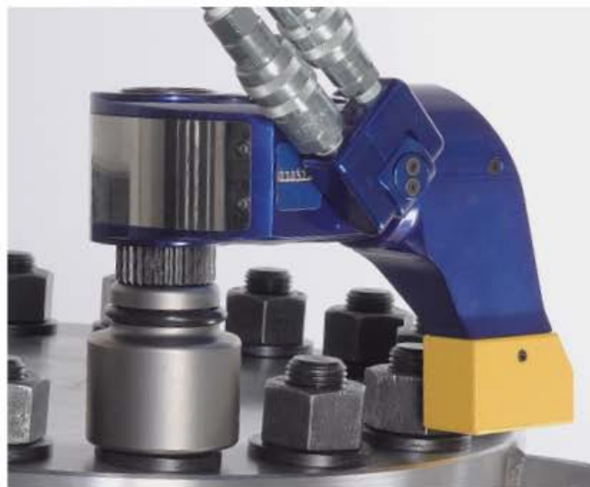
Aparafusando com o braço de reação na ranhura traseira
