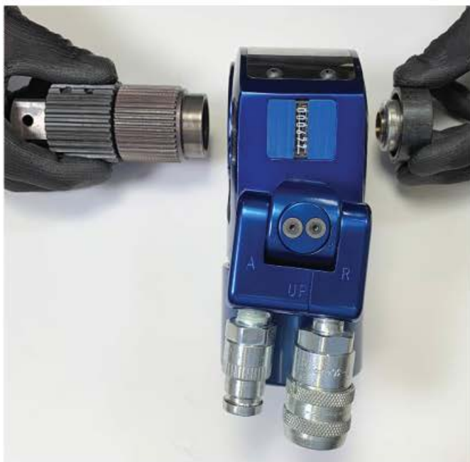
Настройка инструмента для завинчивания
