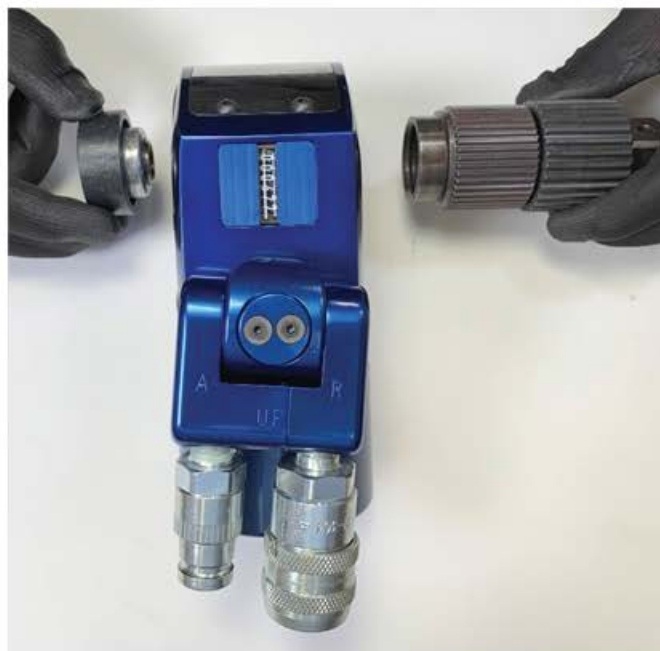
Настройка инструмента для отвинчивания
