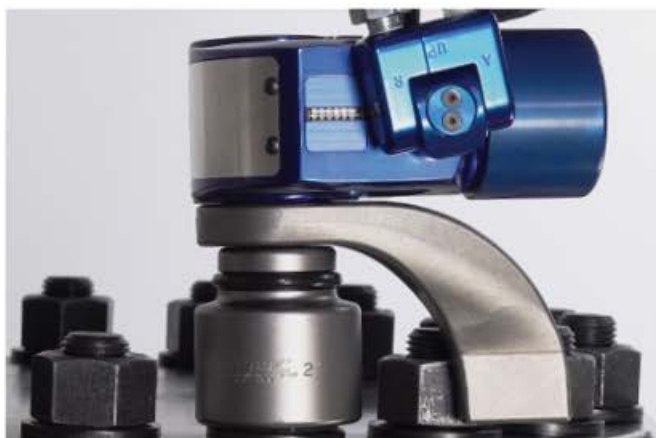
Работа с резьбовыми соединениями при использовании упорного рычага шлица привода
