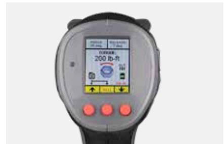
La capacità di registrazione dati integrata consente all'operatore di mantenere un registro di tutti i lavori di bullonatura completati. Per un riscontro oggettivo e un controllo di qualità ottimale, le informazioni possono essere salvate su un PC o su un tablet per fornire una registrazione permanente del lavoro realizzato.
