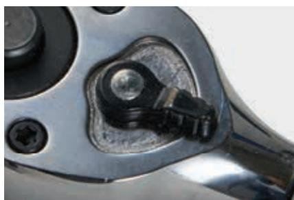
Рычаг обратного хода храповика быстро и удобно переключает направление движения с помощью храповика. У рычага три положения: по часовой стрелке, против часовой стрелки и блокировка.
