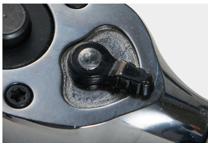
Рычаг обратного хода храповика быстро и удобно переключает направление движения с помощью храповика. У рычага три положения: по часовой стрелке, против часовой стрелки и блокировка.
