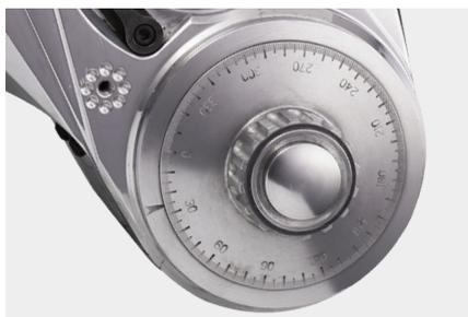
Avec un simple ajout, le système AVANTI est capable de fournir un angle de lecture clair pour les méthodes de serrage qui intègrent la rotation de l'écrou.
