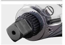
Система AVANTI оснащена запатентованным реактивным приводом (также используется в серии ICE), который позволяет устранить разрушающую силу скручивания, которая возникает в случае использования других динамометрических ключей, оборудованных задним упорным рычагом.
